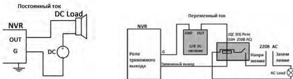
Рисунок 2.5 Подключение тревожного выхода
