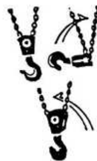
Рис. 6 Неправильное положение крюка.
