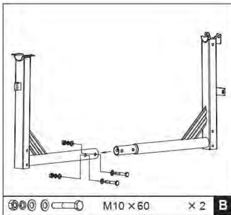
2. Вставьте две половины рамы друг в друга, как показано на рисунке. Вставьте 2 болта M10X60 с шестигранный головкой и шайбами через отверстия с одной стороны, затем плоские шайбы и контргайку, с другой стороны. Затяните.
