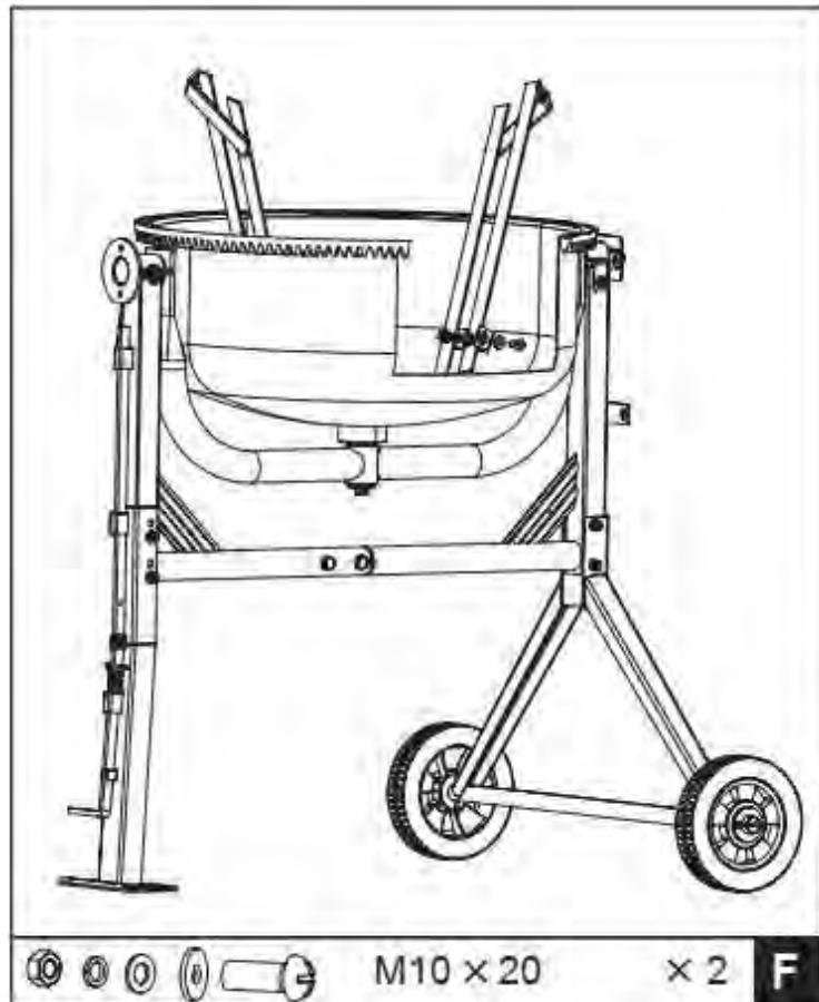
Установите смесительные лопатки внутри нижнего барабана свободно, как показано на рисунке - В основании барабана предусмотрены два отверстия, в которые снаружи можно вставить винт с крестообразной головкой М8Х20. Кожаная шайба и контргайка должны быть свободно навинчены с внутренней стороны. Кожаная шайба должна быть помещена под лезвие вниз по отношению к барабану.
