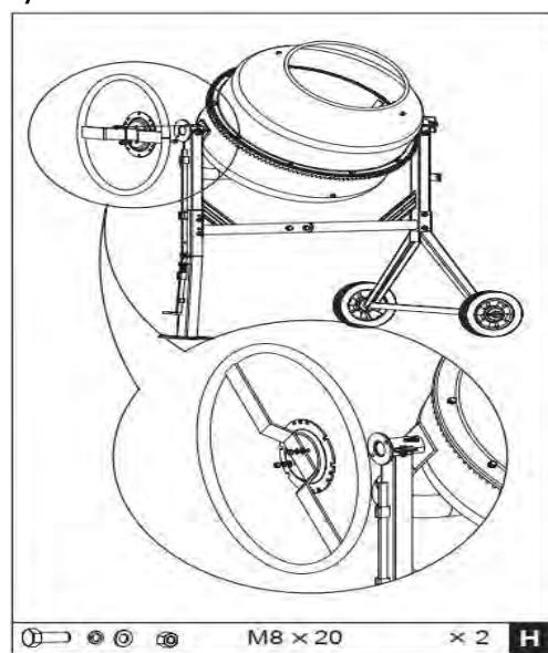
1. Сдвиньте стопорную пластину на вал большого диаметра на конце лапы рамы, при этом обод будет обращен внутрь, как показано на рисунке. Закрепите двумя болтами M8X20, каждый с плоской шайбой и контргайкой.
