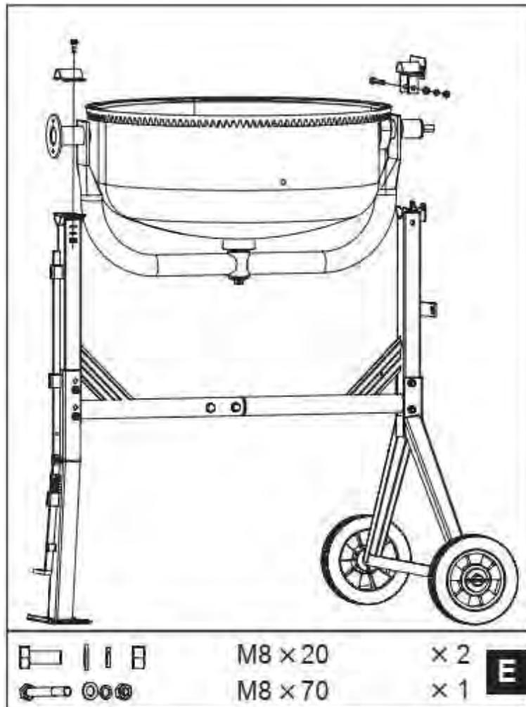
1. Осторожно, вдвоем или втроем, установите нижний барабан с опорным рычагом на боковые опоры стенда, как показано на рисунке, так, чтобы блоки подшипников вставлялись в каналы, предусмотренные боковыми опорами. Вал большего диаметра должен находиться на конце ножки подставки.
