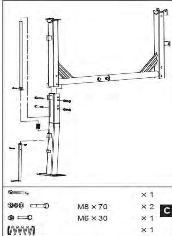
3. К раме, лежащей на боку, прикрепите опорную ногу, как показано на рисунке. Вставьте 2 шестигранных болта M8x70 в отверстия с одной стороны, затем поставьте плоские шайбы, стопорные шайбы и гайки. Наденьте пружину на стержень нижнего плунжера. Скрепите стержни плунжеров, шестигранным болтом м6х30 и гайкой. Для удержания пружины на месте вставьте разжимной шплинт и разогните его концы. Затяните
