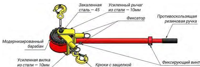
Рисунок 1. Устройство лебедки ручной рычажной модели ЛР.
