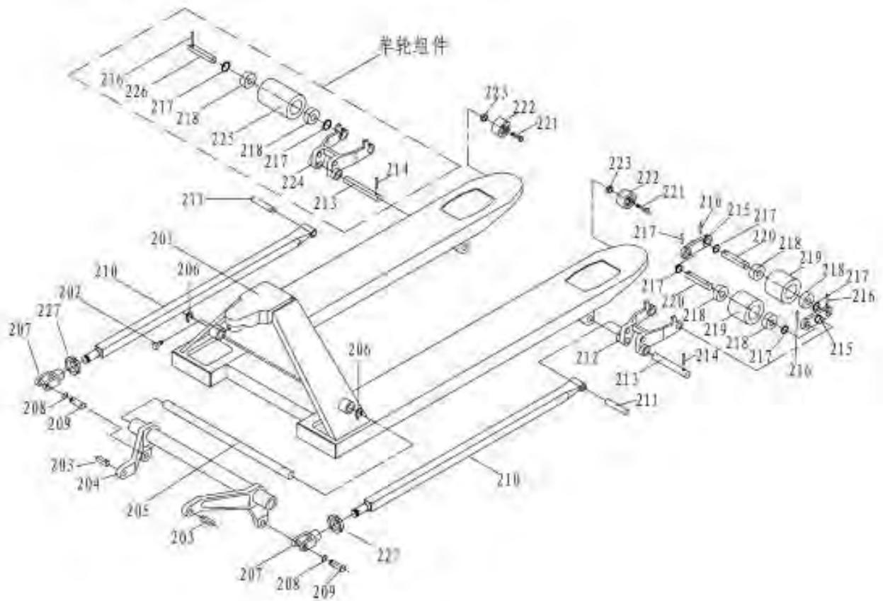
Рисунок 6. Взрыв-схема корпуса тележки RHP.
