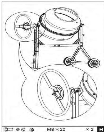
1. Сдвиньте стопорную пластину на вал большого диаметра на конце лапы рамы, при этом обод будет обращен внутрь, как показано на рисунке. Закрепите двумя болтами M8X20, каждый с плоской шайбой и контргайкой.
