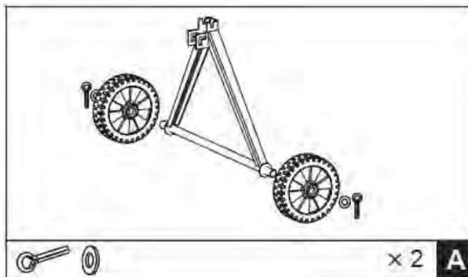
1. Вставьте шплинт в каждое ближайшее к центру отверстие в оси, наденьте на ось шайбы с обеих сторон, наденьте колеса, затем ещё шайбу с каждой стороны и ещё по шплинту с каждой наружной стороны. Отогните концы шплинтов.
