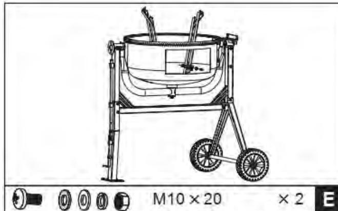
Установите смесительные лопасти внутри нижнего барабана свободно, как показано на рисунке - В основании барабана предусмотрены два отверстия, в которые снаружи можно вставить винт с крестообразной головкой М8Х20. Кожаная шайба и контргайка должны быть свободно навинчены с внутренней стороны. Кожаная шайба должна быть помещена под лезвие вниз по отношению к барабану.
