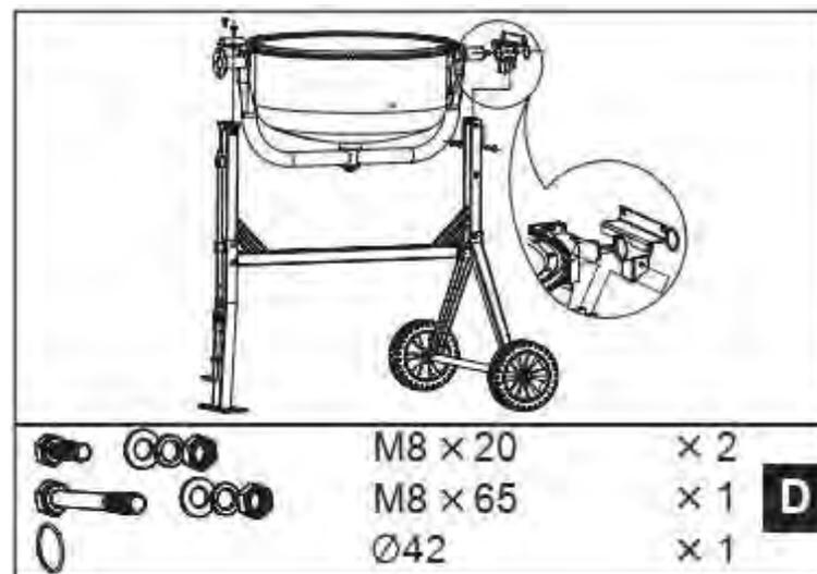
1. Надвиньте подшипниковый узел на вал. Застопорите его спиральным кольцом Ф42.
