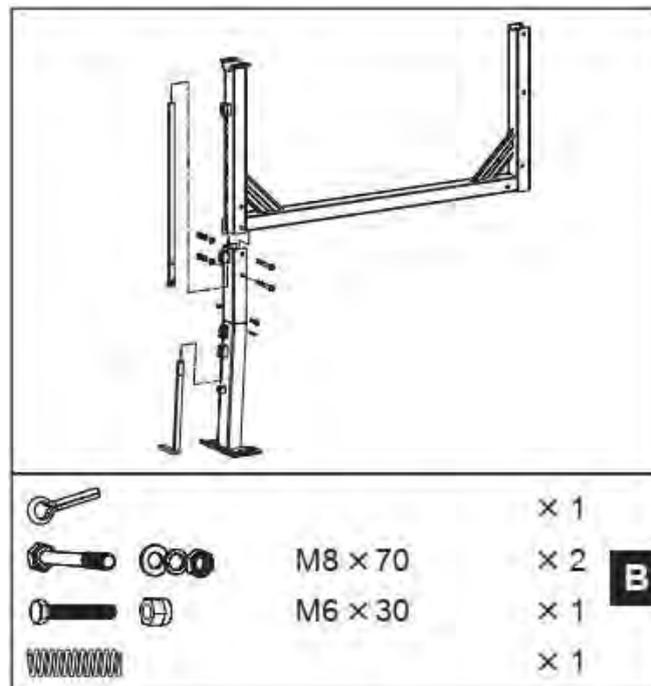
2. К раме, лежащей на боку, прикрепите опорную ногу, как показано на рисунке. Вставьте 2 шестигранных болта М8х70 в отверстия с одной стороны, затем наденьте плоские шайбы, стопорные шайбы и гайки. Наденьте пружину на стержень нижнего плунжера. Скрепите стержни плунжеров шестигранным болтом М6х30 и гайкой. Для удержания пружины на месте вставьте шплинт и разогните его концы. Затяните.
