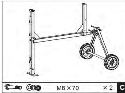
3. Поверните раму и прикрепите кронштейн с осью и колесами таким же способом.
