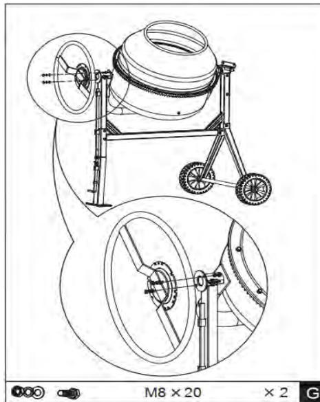
Установите опрокидывающее колесо с фиксирующей тарелкой на фланце рамы и закрепите двумя шестигранными болтами M8x20 с плоскими и стопорными шайбами и гайками.
