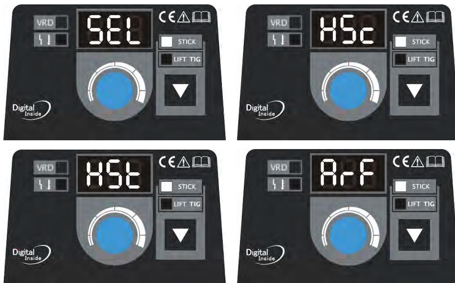
Установите параметры сварочного тока с помощью ручки управления «CURRENT» («AMP»). Обычно значение сварочного тока устанавливают в соответствии с диаметром выбранного электрода и толщиной свариваемой заготовки:
