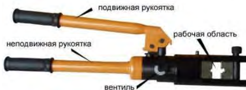
Рис.1 - Составные части опрессовщика кабеля
