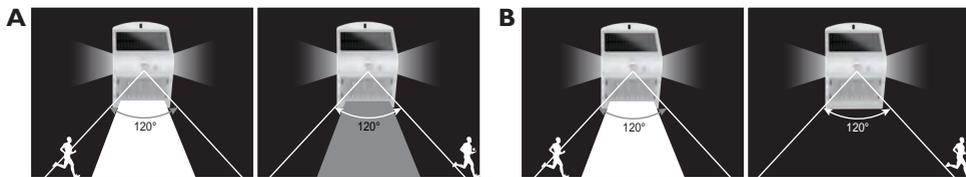
Светильник автоматически начнет светиться только при наступлении темноты. В темное время суток светильник светится от аккумулятора, заряженного в светлое время суток. С наступлением светлого времени суток светильник погаснет.
