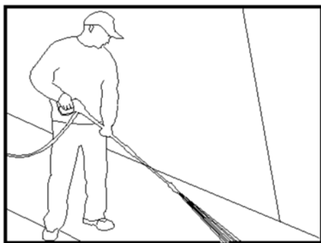
Рис. 6 - Оптимальный угол распыления воды относительно поверхности
