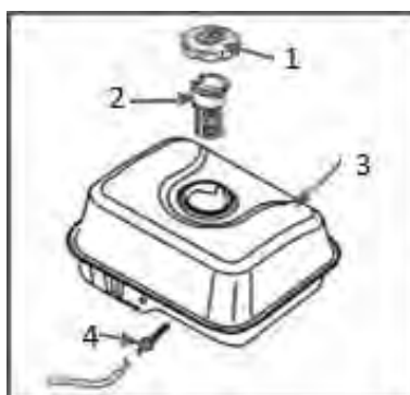
Рис. 22 Расположение топливных фильтров
