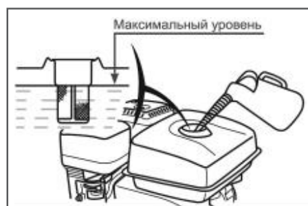
Рис. 13 Максимальный уровень топлива в топливном баке
