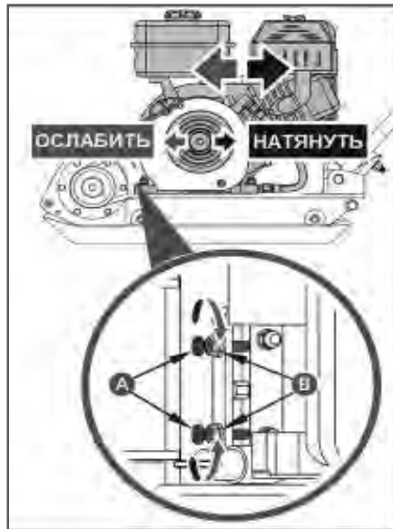
Рис. 30 Регулировка натяжения ремня Т-50
