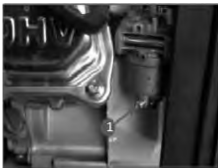
Рис. 24 Обслуживание фильтра отстойника Т-50 1. Винт
