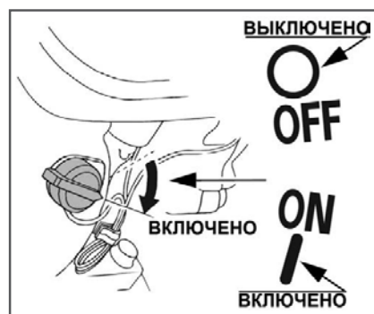
Рис. 12 Выключатель зажигания в положении «Включено»
