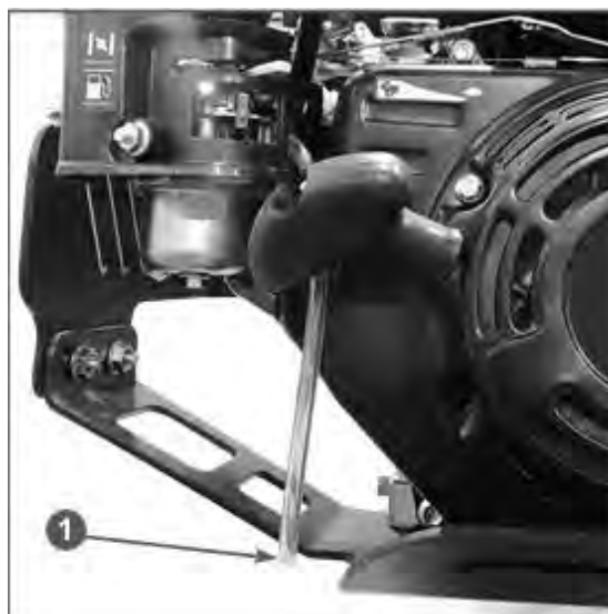
Рис.13 Дренажная трубка карбюратора 1. Трубка дренажная
