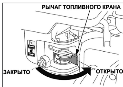
Рис.9 Топливный кран карбюратора
