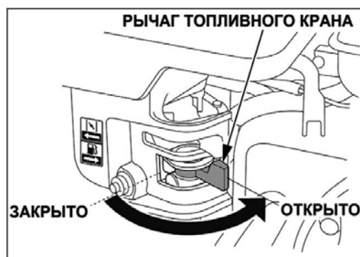
Рис.9 Топливный кран карбюратора
