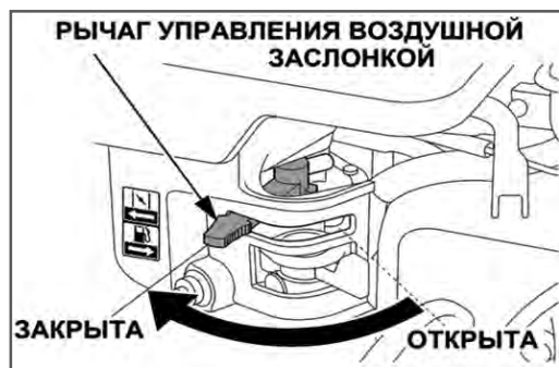
Рис.10 Воздушная заслонка закрыта
