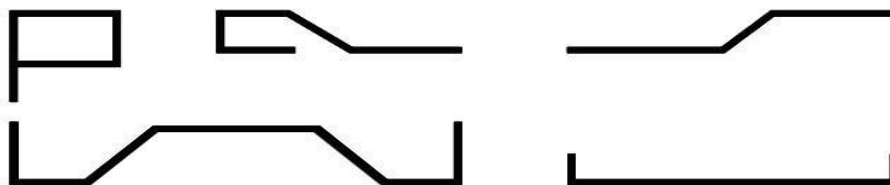
Рис. 1 Формы изгиба арматуры
