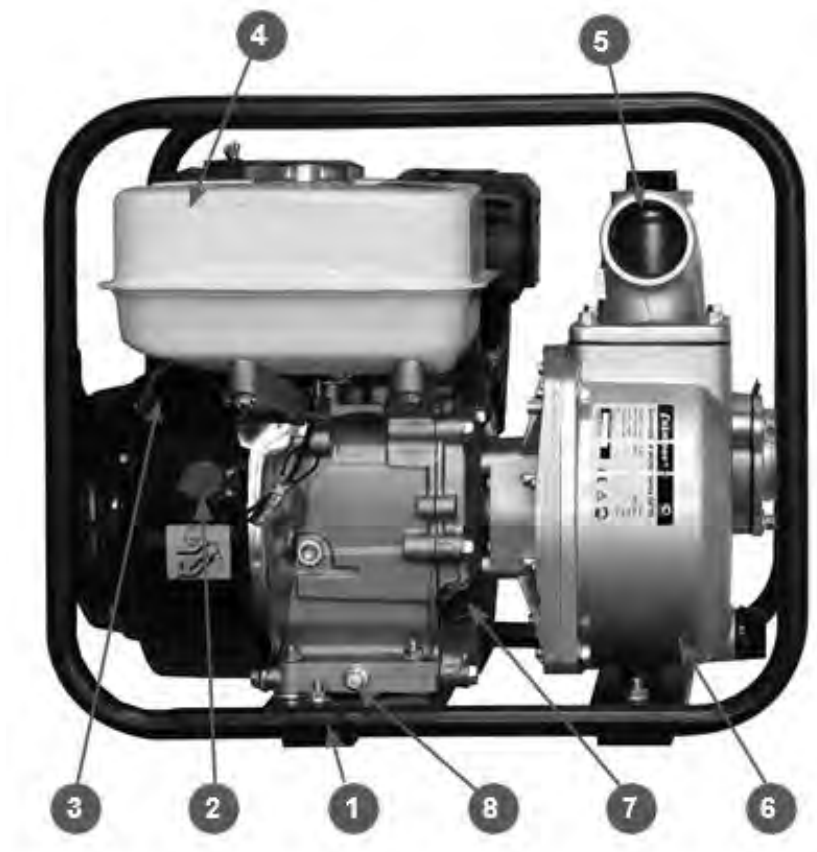
Рис.1 – 1. Рама; 2. Выключатель зажигания; 3. Стартер ручной; 4. Бак топливный; 5. Патрубок выходной (напорный); 6. Корпус насоса; 7. Маслоналивная горловина со щупом; 8. Пробка для слива масла.
