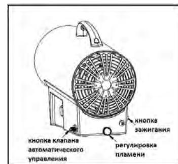
**ПРИМЕЧАНИЕ:** Если нагреватель не загорится, в шланге может быть воздух. В таком случае удерживайте кнопку автоматического регулирующего клапана нажатой и подождите 20 секунд. Отпустите кнопку клапана автоматического управления и подождите 20 секунд, пока несгоревшее топливо не выйдет из нагревателя, повторите шаги 6-8.
