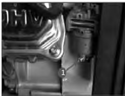
Рис. 24 Обслуживание фильтра отстойника Т-50 1. Винт
