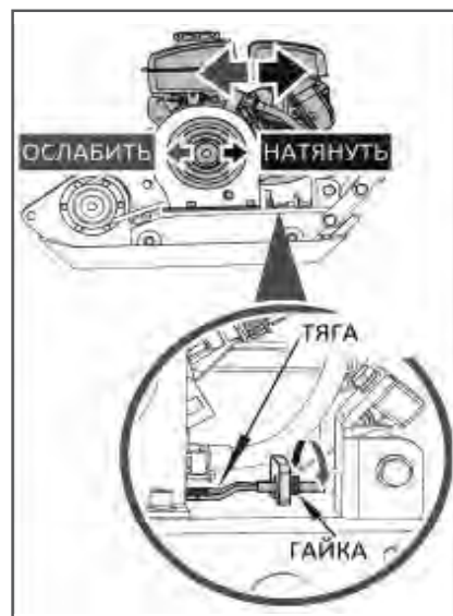
Рис. 31 Регулировка натяжения ремней Т-60, Т-80, Т-90, Т-100. А – болт В - контргайка
