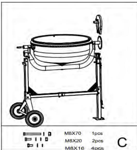
1. С помощью помощников осторожно установите нижний барабан с опорным коромыслом на боковые опоры станины, как показано на рисунке. Закрепите болтом M10x70 с шайбой и гайкой.
