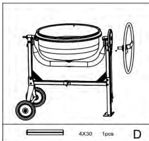
Наденьте поворотное колесо на вал, зафиксируйте цилиндрическим шплинтом 4х30мм.
