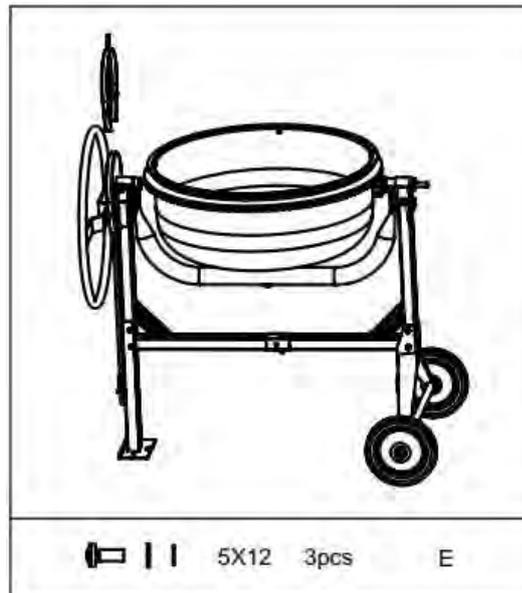
Закрепите защитную крышку винтами 5x12
