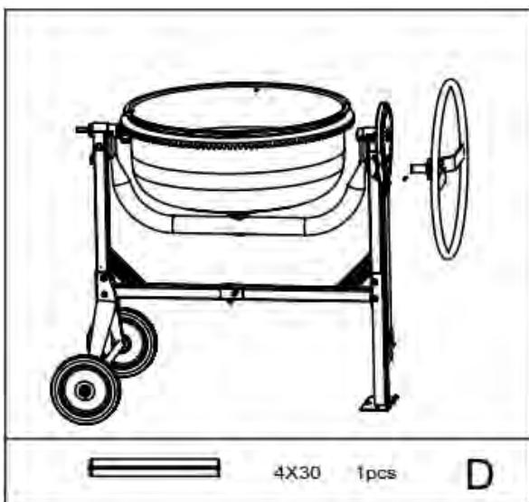
Наденьте поворотное колесо на вал, зафиксируйте цилиндрическим шплинтом 4x30мм.
