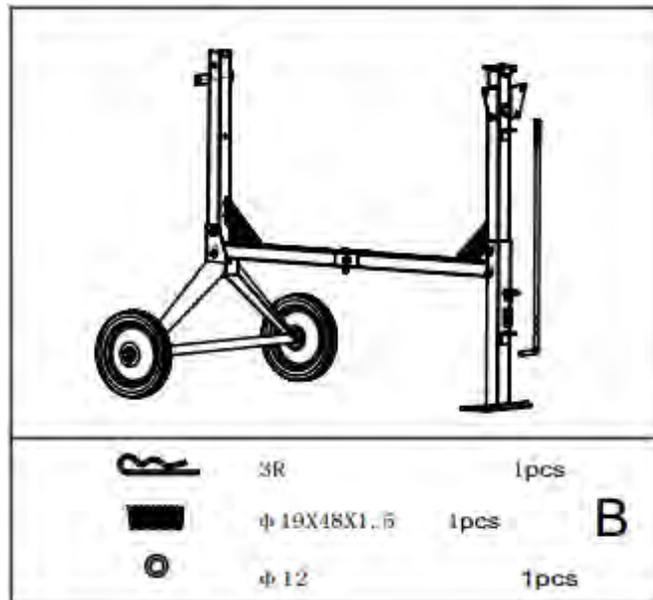
Проденьте фиксирующий стержень через верхнюю раму снизу-вверх, закрепите.
