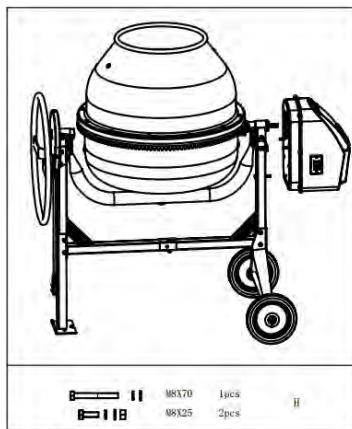
Установите коробку трансмиссии надвинув ее на вал, при этом шпоночные пазы должны быть совмещены. Закрепите ее болтами. Затяните.
