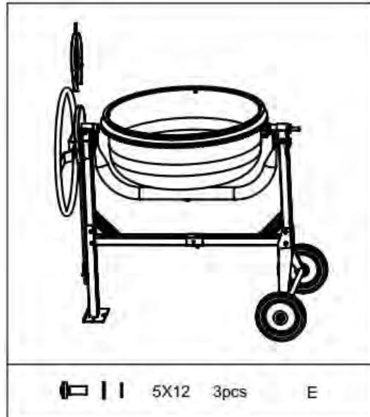
Закрепите защитную крышку винтами 5x12
