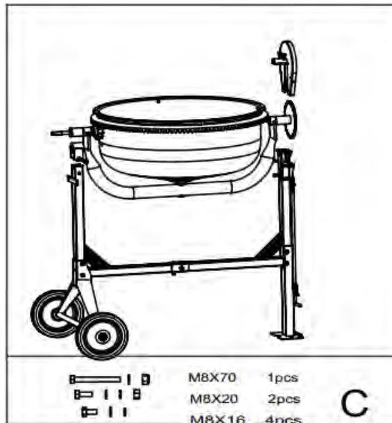
1. С помощью помощников осторожно установите нижний барабан с опорным коромыслом на боковые опоры станины, как показано на рисунке. Закрепите болтом М10х70 с шайбой и гайкой.
