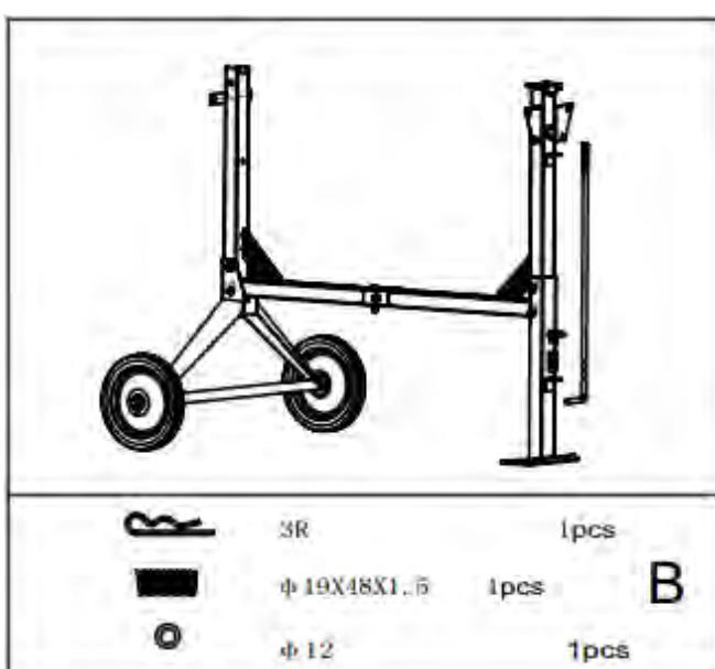
Проденьте фиксирующий стержень через верхнюю раму снизу-вверх, закрепите.
