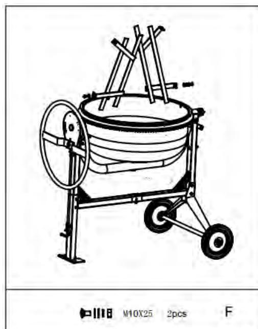
Установите смесительные лопатки внутри нижнего барабана свободно, как показано на рисунке - В основании барабана предусмотрены два отверстия, в которые снаружи можно вставить винт с крестообразной головкой М10Х25. Кожаная шайба и контргайка должны быть свободно навинчены с внутренней стороны. Кожаная шайба должна быть помещена под лезвие вниз по отношению к барабану.
