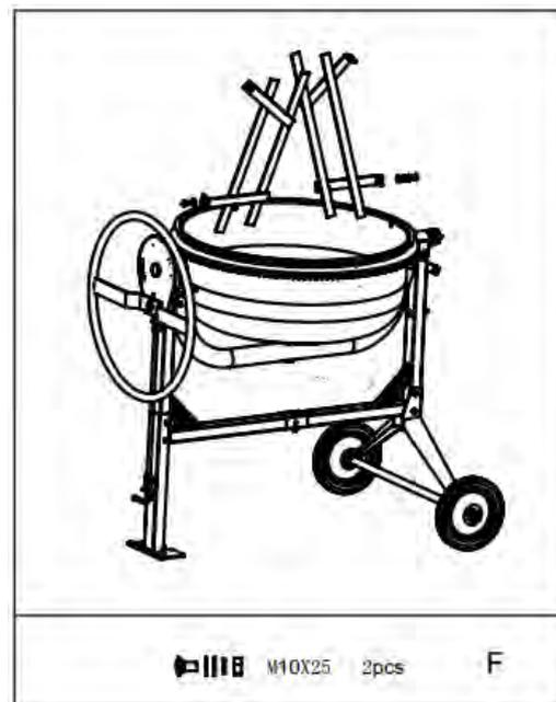
Установите смесительные лопатки внутри нижнего барабана свободно, как показано на рисунке - В основании барабана предусмотрены два отверстия, в которые снаружи можно вставить винт с крестообразной головкой M10X25. Кожаная шайба и контргайка должны быть свободно навинчены с внутренней стороны. Кожаная шайба должна быть помещена под лезвие вниз по отношению к барабану.
