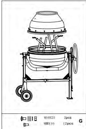
1. Расположите верхний барабан на нижнем барабане над ободом, убедившись, что монтажные отверстия совмещаются как в обоих, так и в обозначенных стрелках.
