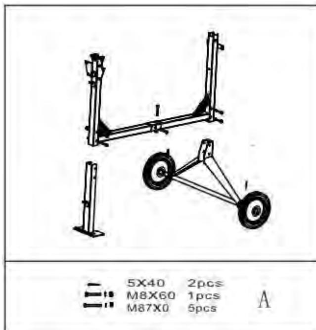
1. Вставьте шплинт в каждое ближайшее к центру отверстие в оси, наденьте на ось шайбы с обеих сторон, наденьте колеса, затем ещё шайбу с каждой стороны и ещё по шплинту с каждой наружной стороны. Отогните концы шплинтов.
