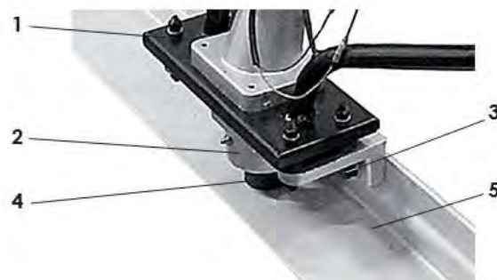
Рис.3 1 – Основание рамы; 2 – Корпус вибратора; 3 – Болт крепления; 4 – Амортизатор; 5 – Рейка выравнивающая.
