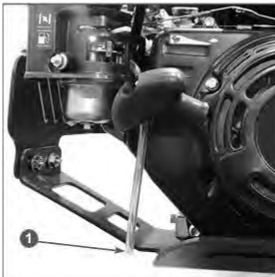
Рис.13 - Дренажная трубка карбюратора 1. Трубка дренажная
