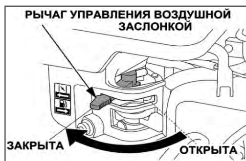
Рис.10 - Воздушная заслонка закрыта
