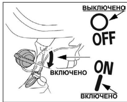
Рис. 12 - Выключатель зажигания в положении «Включено»
