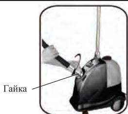
**Примечание.** Не переносите отпариватель за телескопическую стойку. Корпус отпаривателя тяжелый, особенно с полным резервуаром, крепление стойки может не выдержать и отпариватель упадет.
