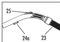
Всмоктувальний шланг (23) та коліно із вбудованим кріпленням для запірнього клапана (24a) та механічним регулятором потужності всмоктування (25)
