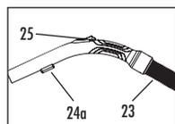
Всасывающий шланг (23) с креплением запорного вентиля (24а) и мех. регулированием силы всасывания (25)
