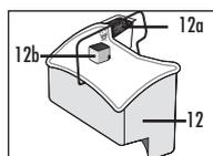
Резервуар для грязной воды (12), включая «мокрый» фильтр (12а) и поплавков (12b)<sup>2</sup>
