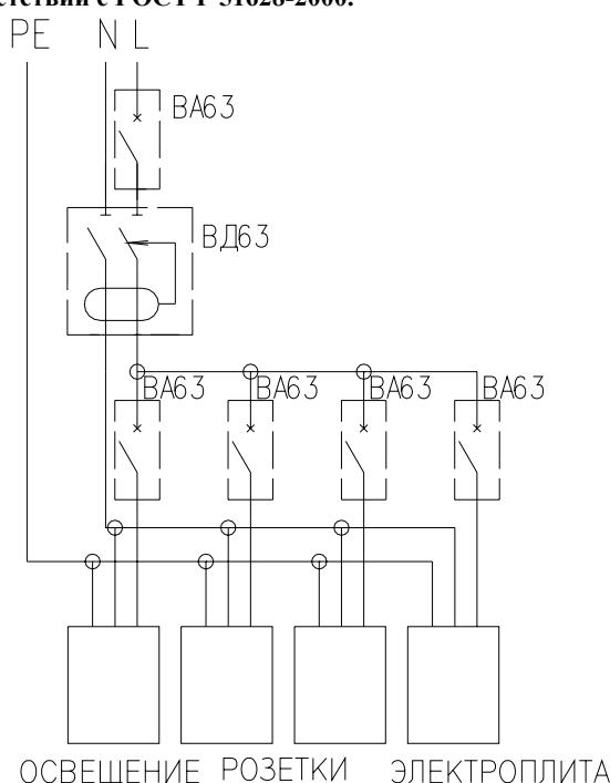
**5.4. ПРИМЕР применения дифференциального выключателя нагрузки ВД63 в групповом распределительном щитке для индивидуального здания в соответствии с ГОСТ Р 51628-2000.**
