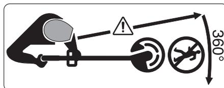
Se till att personer, som befinner sig i närheten inte skadas av ivägslungade främmande föremål.
