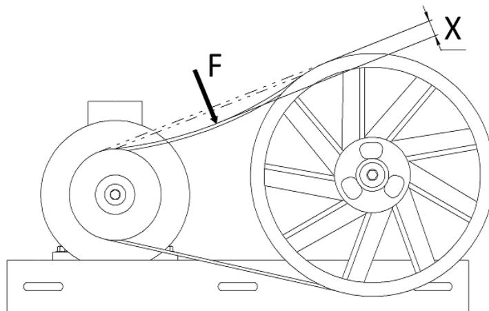
**Помните!** Чрезмерное натяжение клинового ремня ведет к его преждевременному износу и дополнительной нагрузке на подшипники и их повышенному износу, перегреву электродвигателя и компрессорного блока. Недостаточное натяжение клинового ремня ведет к его нагреву и проскальзыванию на шкивах клиноременной передачи, снижению величины крутящего момента на валу компрессорного блока, а следовательно к снижению производительности компрессора.
