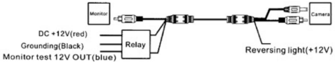
В. Если у камеры выходной разъем RCA и разъем питания миниджек ,соединения является следующим:
