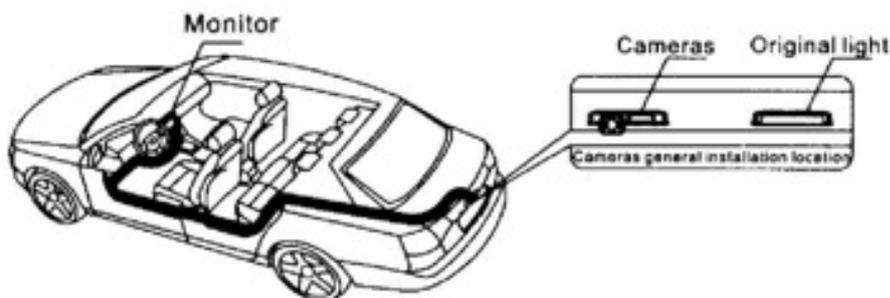
Вариант Б: Универсальный тип камеры устанавливается в пластиковую рамку номерного знака (для камер VDC-006, VDC-007, VDC-008).
