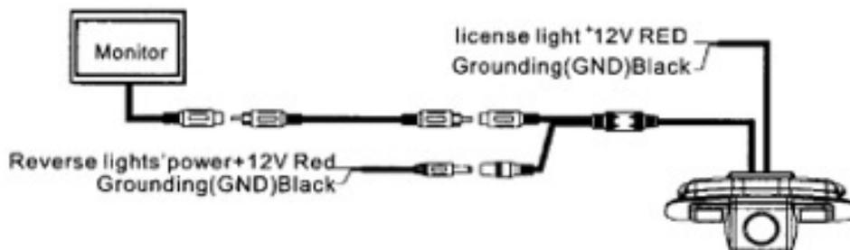
Б. Подключение универсальной камеры без подсветки номерного знака.
