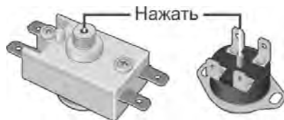
Рисунок 3. Схема расположения кнопки термовыключателя
