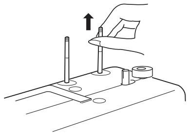
Катушечные стержни удерживают катушку с ниткой для подачи ее в машину. Чтобы воспользоваться катушечным стержнем, вытяните его наверх. Для хранения утопите вниз.
