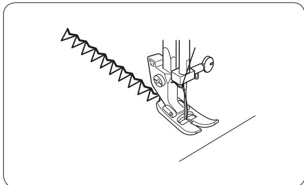
Если подача ткани вперед или назад становится несбалансированной из-за типа ткани, отрегулируйте баланс при помощи регулятора длины стежка:
