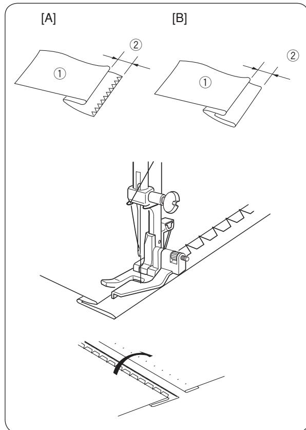
1 При работе с тяжёлыми тканями, края которых могут распускаться, сначала обработайте край.
