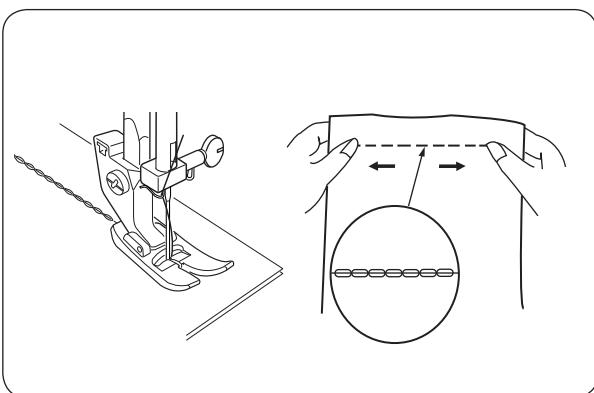
Этот прямой и прочный стежок рекомендуется использовать там, где для обеспечения комфорта и долговечности необходимы прочность и эластичность. Используйте его для усиления пройм и швов на брюках, а также на трикотажных и стречевых тканях, чтобы избежать сборок. Так же используйте его для обеспечения прочности, например, на рюкзаках.
