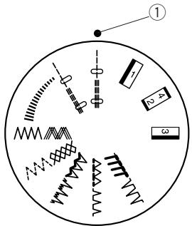
Поднимите иглу и прижимную лапку. Совместите символ нужной строчки с установочной отметкой на панели, повернув регулятор выбора строчек.
