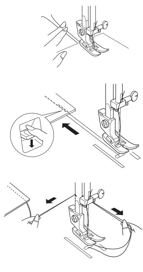
1 Поднимите прижимную лапку и расположите ткань в соответствии с направительными линиями на игольной пластине.
