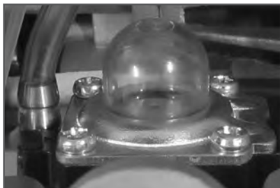
Рис. 8 Расположение ручного топливного насоса
