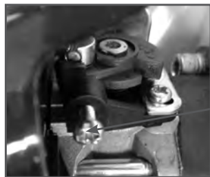
Рис. 16 Винт настройки оборотов холостого хода
