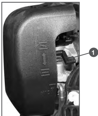
Рис. 9 Расположение воздушной заслонки
