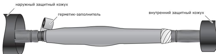
**9.1** Используя герметик-заполнитель из комплекта муфты произвести намотку на края толстостенных манжет с заходом на полупроводящий слой. При намотке герметик вытягивать примерно в 1,5–2 раза.
