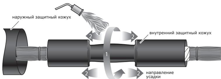
10.1 Надвинуть внутренний защитный кожух на место соединения жил, разместить его по центру муфты и усадить, начиная с середины.
