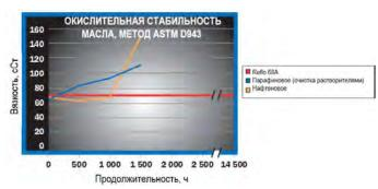
Высокая окислительная стабильность REFLO A предотвращает разложение масла в системе при попадании в нее воздуха или кислорода. Менее частые замены масла могут сократить дорогостоящий простой.
