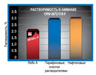
Компрессорное масло REFLO A меньше растворяется в аммиачном хладагенте по сравнению с очищенными растворителями парафиновыми и нафтеновыми маслами. Это может повысить производительность и кпд системы, а также обеспечить более эффективную защиту от износа.
