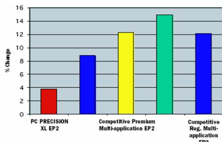
**Повышенная стабильность на сдвиг при средних скоростях смазки PRECISION XL EP1 увеличивает интервал замены.**
