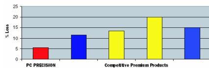
**Повышенная устойчивость к вымыванию водой смазки PRECISION XL EP2 снижает необходимость частой смазки оборудования.**
