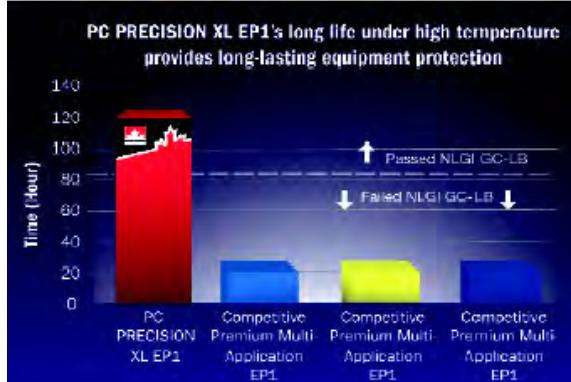
Сравнение результатов испытания ресурса подшипника по стандарту ASTM D3527 при 160°C, скорости 1000 об/м и осевом давлении 111 Н для смазок PRECISION XL EP1 и универсальных высококачественных аналогов других лидирующих производителей.
