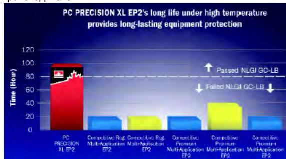
Сравнение результатов испытания ресурса подшипника по стандарту ASTM D3527 при 160°C, скорости 1000 об/м и осевом давлении 111 Н для смазок PRECISION XL EP2 и универсальных высококачественных аналогов других лидирующих производителей.
