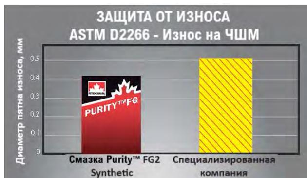
Пластичная смазка PURITY FG2 Synthetic обеспечивает почти такую же противоизносную защиту, что и синтетическая пищевая смазка специализирующегося на таких смазочных материалах производителя. При меньшем износе меньше остановок производства, больше производительность и меньше затраты на техническое обслуживание.
