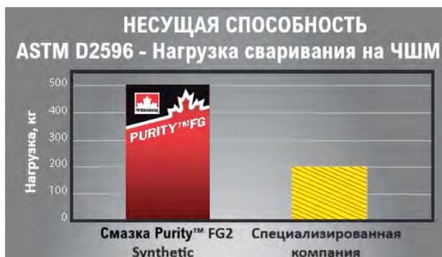
Пластичная смазка PURITY FG2 Synthetic обладает более эффективной несущей способностью по сравнению с синтетической пищевой смазкой специализирующегося на таких продуктах производителя, поэтому PURITY FG2 Synthetic идеально подходит для применения в пищевом оборудовании при более тяжелых нагрузках.
