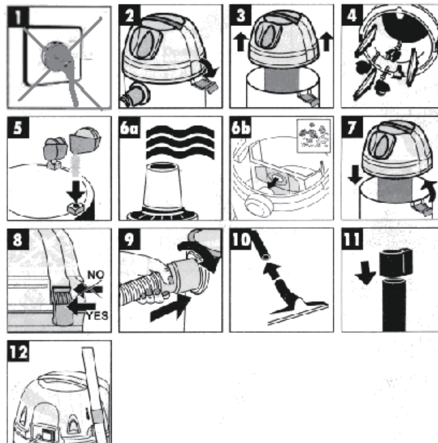
Figure 6a: Nettoyage à l'aspirateur humide à l'aide du filtre en mousse fourni
