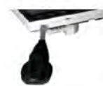
Чтобы вскрыть терморегулятор, поместите конец плоской отвертки в обе разъемы в основании терморегулятора.
