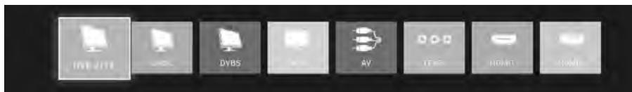
Нажмите кнопку INPUT на пульте ДУ, чтобы выбрать источник сигнала ТВ. Выберите требуемый источник сигнала с помощью кнопок ◀ и ▶, затем нажмите «OK», чтобы подтвердить выбор.
