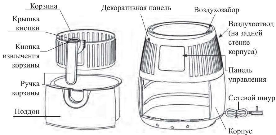
Принцип работы аэрогриля основан на конвекции воздушных потоков от нагревателя внутри рабочей емкости. Вентилятор, расположенный в верхней части аэрогриля, приводит в движение воздушные массы, нагретые до высокой температуры ТЭНом (трубчатый электронагреватель). Горячий воздух циркулирует внутри рабочей емкости аэрогриля и нагревает продукты до нужной кондиции.
