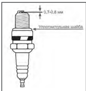
Рис.24 Обслуживание свечи зажигания.
