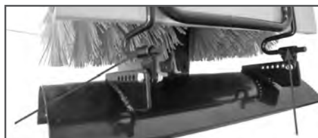
Рис. 5 Установка отвала на кронштейны щетки
