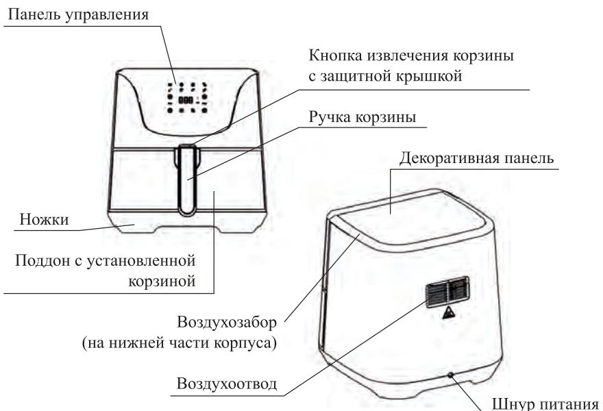
Принцип работы аэрогриля основан на конвекции воздушных потоков от нагревателя внутри рабочей емкости. Вентилятор, расположенный в верхней части аэрогриля, приводит в движение воздушные массы, нагретые до высокой температуры ТЭНом (трубчатым электронагревателем). Горячий воздух циркулирует внутри рабочей емкости аэрогриля и нагревает продукты до нужной кондиции.
