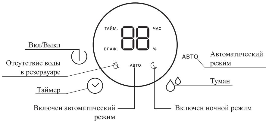
**Кнопка «Вкл/Выкл»** включает и выключает увлажнитель. При нажатии на кнопку включается интенсивность тумана 2.
