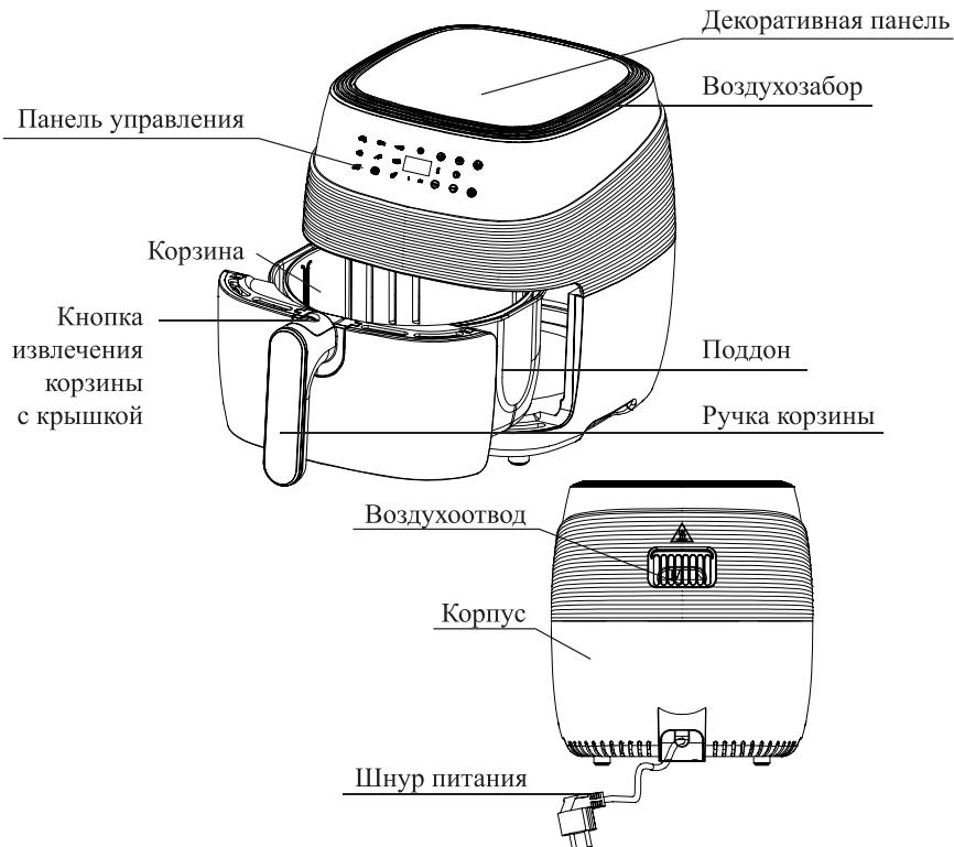
Принцип работы аэрогриля основан на конвекции воздушных потоков от нагревателя внутри рабочей емкости. Вентилятор, расположенный в верхней части аэрогриля, приводит в движение воздушные массы, нагретые до высокой температуры ТЭНом (трубчатым электронагревателем). Горячий воздух циркулирует внутри рабочей емкости аэрогриля и нагревает продукты до нужной кондиции.
