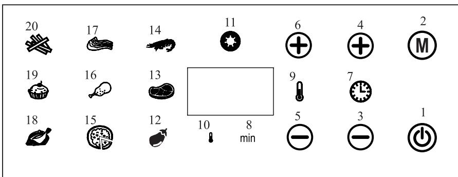
1 — кнопка включения. Кнопка горит на панели управления когда устройство подключено к сети. Для включения устройства нужно нажать и удерживать кнопку в течение двух секунд. Когда аэрогриль включен, при однократном нажатии на кнопку начнется процесс приготовления блюда. По умолчанию в настройках время установлено на 15 минут, а температура — на 200 °С. Повторное секундное нажатие на кнопку ставит процесс готовки на паузу. Повторное удержание кнопки в течение трех секунд выключит устройство.
