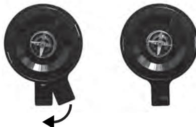
4. Установите мерный колпачок в крышку чаши и зафиксируйте его, повернув по часовой стрелке до щелчка.
