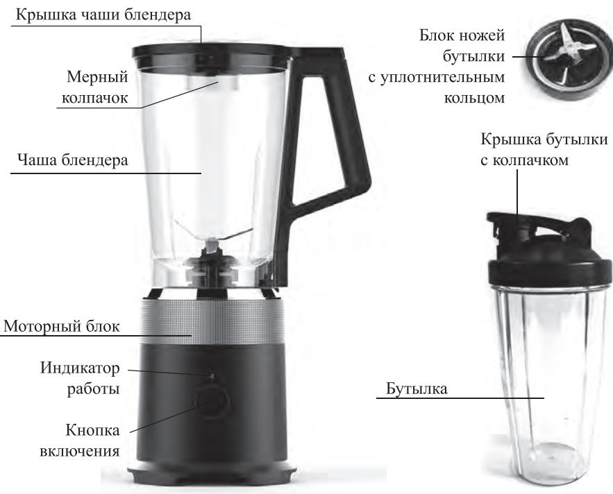
На моторном блоке блендера расположена **кнопка включения**
