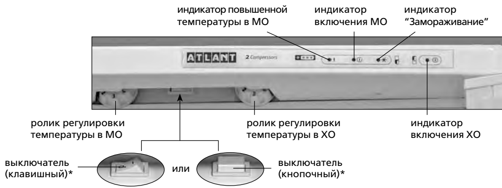
Рисунок 3 — Органы управления и индикации
