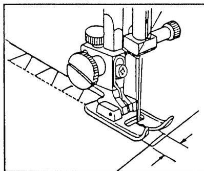
Настоящая строчка применяется для соединения бортовки из тяжелой ткани. Перекрывать два края внахлестку и соединить бортовки строчкой.
