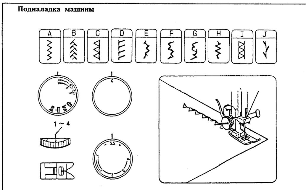
В случае, если не балансируются подачи ткани вперед и назад в зависимости от вида ткани, надо корректировать баланс, поворачивая ручку регулировки длины стежка:
