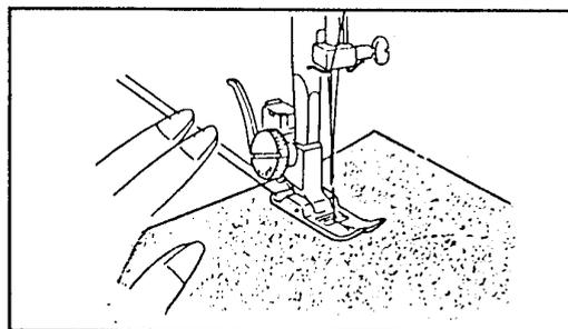
Поднять нажимную лапку и расположить шиваемую ткань рядом с контрольной линией игольной пластинки.
