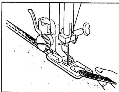
Опустить лапку и выполнить строчку, приподнимая край ткани с обеспечением лавной и равномерной подачей обрабатываемой ткани.
