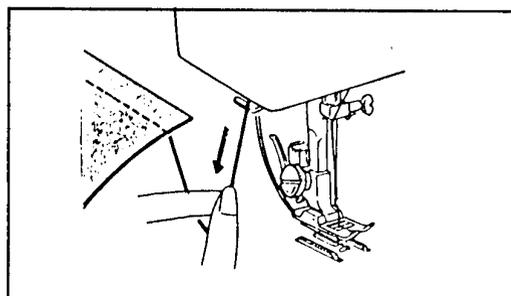
Отрезать нитки на соответствующую длину для выполнения следующей строчки.
