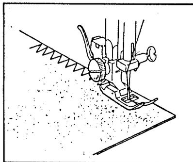
Строчка этого типа применяется для предохранения ткани от разлохмачивания ее необработанных кромок.
