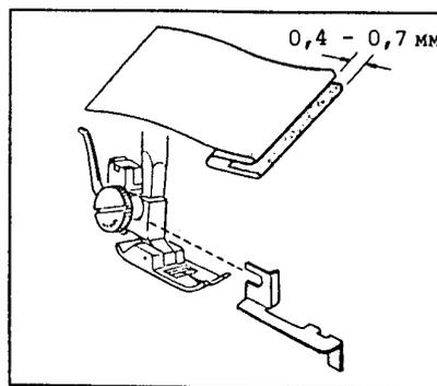
Подгибать ткань вкладку на требуемую ширину и прикрепить ее шпилькой. Затем перегибать подогнутый край, как показано выше. Опустить нажимную лапку, затем ослабить затяжку винта крепления держателя лапки и установить специальное загибочное приспособление размещена в середине носиков нажимной лапки.
