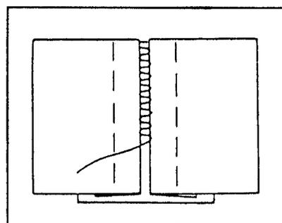
Загнуть край каждой соединяемой штуки ткани на 1,5 см и заутюжить края. Прикрепить две штуки ткани к бумажной или тканевой подкладке в расстоянии между краями 0,2 - 0,3 см. Выполнить строчку, осторожно направляя ткань, чтобы надежно соединить два края стежками.
