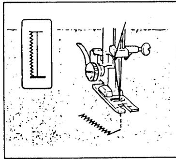
Установить ручку регулировки ширины строчки в положение "2", выполнить 5 стежков закрепки конца петли и поднять иглу из ткани.
