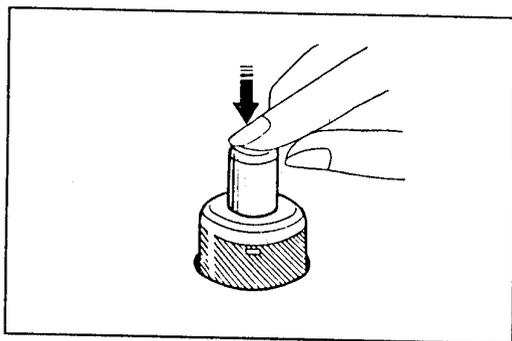
Для увеличения давления лапки на ткань нажать на кнопку регулятора до такого положения, чтобы получить нужное давление.
