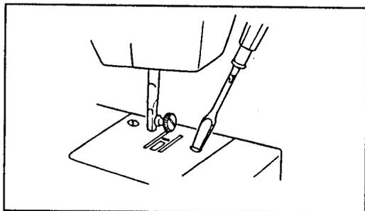
Снять иглу и нажимную лапку.
