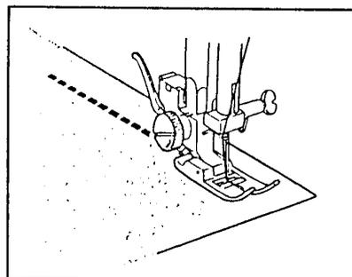
Строчка выполняется с двумя стежками вперед и одним стежком назад с обеспечением прочного неравпарываемого шва.
