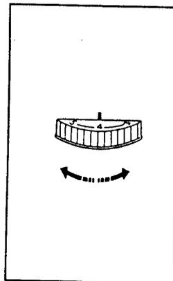
Нужный номер ручки регулировки натяжения нитки установить на контрольную метку.
