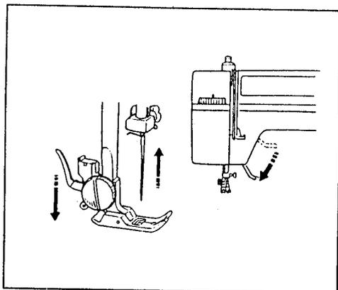
Поворачивая маховое колесо в направлении к себе, поднять иглу вверх и опустить нажимную лапку вниз.
