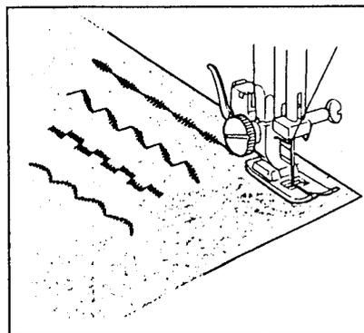
Выполнить пробные стежки и отрегулировать натяжение ниток так, чтобы верхняя нитка была видна с обратной стороны ткани.
