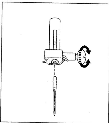
Ослабить затяжку винта, крепящего иглу, поворачивая его к себе.
