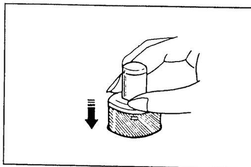
Для снятия давления лапки нажать обойму, при этом кнопка под действием пружины поднимается вверх до крайнего верхнего положения.
