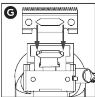
После выровняйте отверстия под винты в ноже и корпусе машинки. Перед полным закреплением ножей, переверните машинку и зафиксируйте нижний нож таким образом, чтобы зубцы верхнего и нижнего ножей находились параллельно друг другу, но при этом зубцы нижнего ножа слегка выступали вперёд над верхним ножом. Важно! Неправильная установка нижнего и верхнего ножей может привести к повреждению кожи при стрижке волос.
