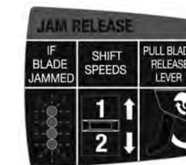
Wenn die Schneidmesser klemmen blinken alle 4 LED. Schiebescalter zwischen 1 und 2 hin und her schieben und den Schalterdrücker zum Öffnen der Schneidmesser drücken.
