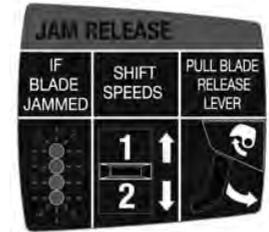
切割刀卡住时，四个LED灯都开始闪亮。应把滑动开关在1和2位之间往来移动并为打开切割刀按开关按钮。
