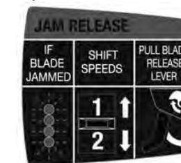
Dacă sunt blocate cuțitele de tăiere, atunci se aprind intermitent toate cele 4 LED-uri. Comutatorul culisant se împinge înainte-înapoi între 1 și 2, și se apasă butonul pentru deschiderea cuțitelor.
