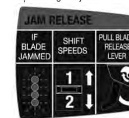
Ja griezējnaži saķēras, iedegas visas 4 gaismas diodes. Kustīgo slēdzi pārslēgt no pozīcijas 1 uz 2 un nospiegt slēdža pogu, lai atvērtu griezējnažus.
