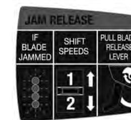
Když se řezné nože zaseknou, blikají všechny 4 LED diody. Posuvný spínač přesouvejte mezi 1 a 2 sem a tam a kvůli otevření řezných nožů stiskněte tlačítko spínače.
