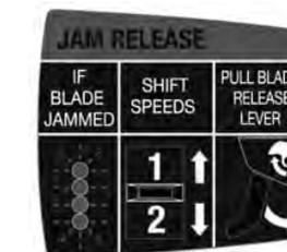
\*Als de snijmessen klemmen, knippen alle 4 leds. Schuifschakelaars 1 en 2 heen en weer schuiven en de drukschakelaar indrukken om de snijmessen te openen.
