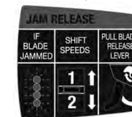
Se todos os 4 LEDs piscarem, deslize o interruptor correção entre a posição 1 e 2 e pressione o botão do interruptor para abrir as facas de corte.
