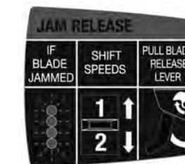
Ha a vágókések megszorultak, mind a 4 LED világít. Tolja a tolókapcsolót az 1-es és a 2-es állás között ide-oda, és nyomja meg a nyomógombos kapcsolót a vágókések nyitására.
